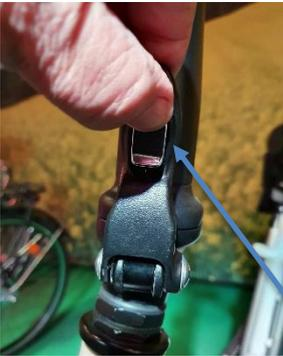
Vor dem Klappen müssen Sie den kleinen Sicherungshebel nach oben schieben.
