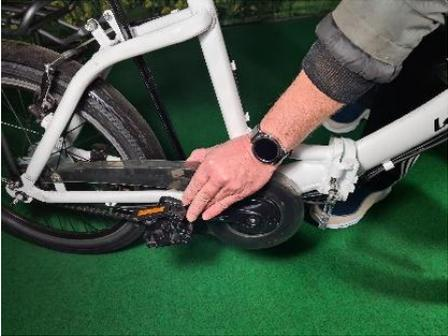
Vor dem eigentlichen Faltvorgang können noch die Pedale eingeklappt werden und es sollte der Ständer ebenfalls eingeklappt werden.
