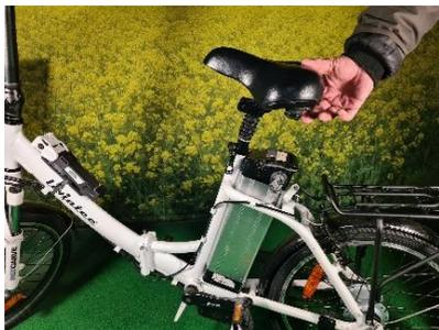
1. Klappen Sie den Sattel mittels des Hebels nach oben.
