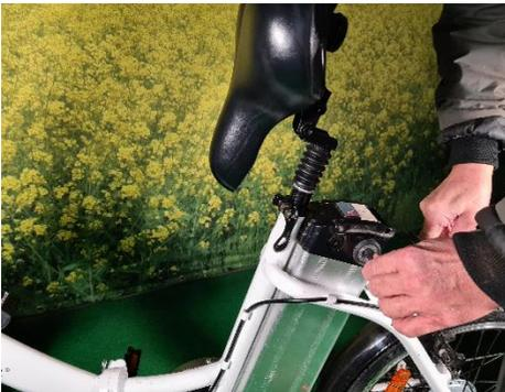
2. Drücken Sie das Schloss in den Akku und drehen Sie dabei den Schlüssel einmal nach rechts. Aus dem Akku schiebt sich eine Verriegelungsnase in die Akkuschiene, der Akku kann somit nicht mehr herausgezogen werden und ist vor Diebstahl und Verrutschen geschützt. Um die Elektrounterstützung zu aktivieren drehen Sie den Schlüssel noch eine Stufe weiter nach rechts.
