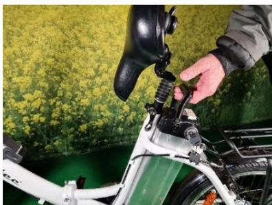
2. Um den Akku zu entnehmen, drücken Sie den Schlüssel in das Schloss hinein und drehen Sie ihn dabei noch eine weitere Drehung nach links. Die Sicherungsnase wird eingefahren.
