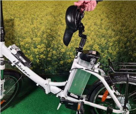
1. Klappen Sie den Sattel nach oben, indem Sie den Hebel unter dem Sattel nach oben drücken. Nun kann der Akku eingesetzt werden. Bitte achten Sie darauf, dass der Akku genau in die Akkuschiene eingeführt wird. Am Ende ist ein wenig Druck von oben erforderlich, um den Akku richtig auf die Anschlusskontakte zu schieben. Zwischen der Akkubodenplatte und dem Akkuboden darf kein Schlitz sein.
